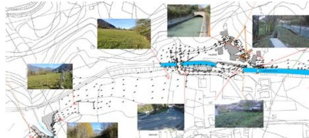
L'intervento prevede la dismissione degli attuali 3 impianti di sedimentazione di tipo Imhoff a servizio delle frazioni del comune di Pontey e di addurre le relative portate nere all'impianto di depurazione di Glareyaz a Chatillon attraverso un collettore di 4 km realizzato con tubazione in PVC di diametro variabile da DN 250 a 315 mm.
