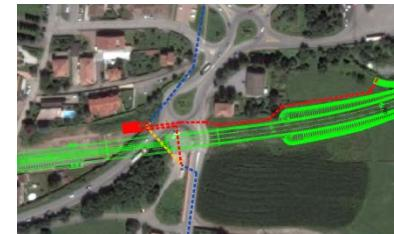
Gli interventi riguardano la realizzazione, quale risoluzione dell'interferenza fra il collettore societario e la nuova linea ferroviaria Arcisate-Stabio, di una stazione di sollevamento a monte dell'attraversamento ferroviario e dei relativi condotti in pressione di scavalco della soletta di copertura della galleria con immissione nell'esistente collettore a gravità posto a valle.
